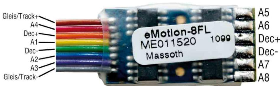
Abbildung 2: eMOTION 8FL Decoder Anschlußbelegung (Ansicht Kabelseite)
