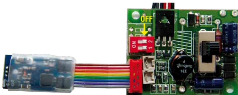
Abbildung 1: eMOTION 8FL Funktionsdecoder an LGB Digitalschnittstelle
