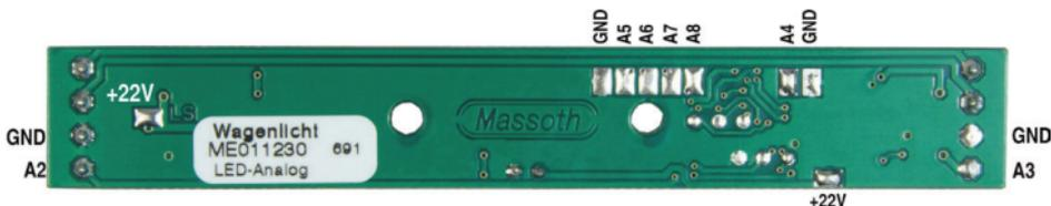
Abbildung 4: Belegung der zusätzlichen Anschlussmöglichkeiten (Sicht ist von unten)
