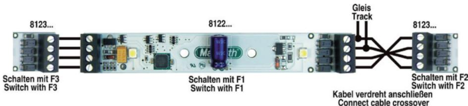
Abbildung 3: Anschluss der Digitalversion in Verbindung mit Analogplatinen zur Erweiterung
