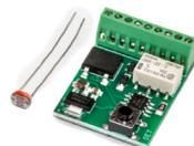
Das Modul schaltet die Beleuchtung abhängig von der Helligkeit ein bzw. aus.
